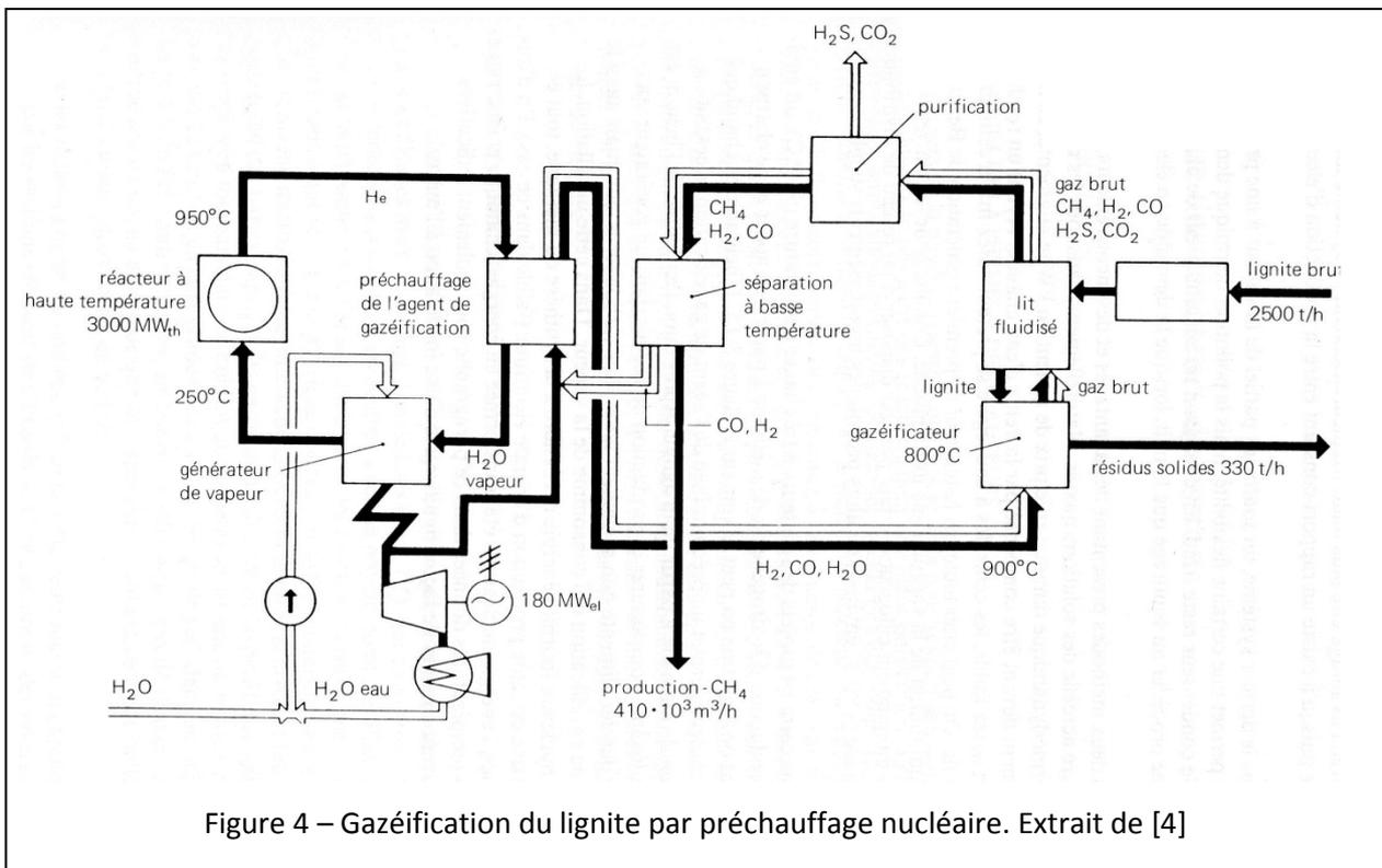
Figure 4 – Gazéification du lignite par préchauffage nucléaire. Extrait de [4]
