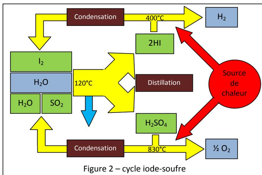
Comme indiqué sur le schéma, le soufre et l'iode sont récupérés et réutilisés, ce qui fait que le procédé global peut être considéré comme un cycle. Il constitue un moteur thermique-chimique dont l'entrée de chaleur sont les réactions de décomposition de l'acide sulfurique et de l'iodure d'hydrogène (représentées par les flèches rouges) et la sortie est la synthèse de ceux deux derniers (représentée par la flèche bleue).
