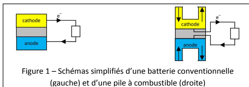
Le deuxième inconvénient peut être détourné avec l'utilisation du dihydrogène, combustible dont l'oxydation ne libère que de l'eau. Bien qu'il soit extrêmement inflammable (ce qui rend son stockage dangereux) il peut être stocké en grande échelle (contrairement à l'électricité).
